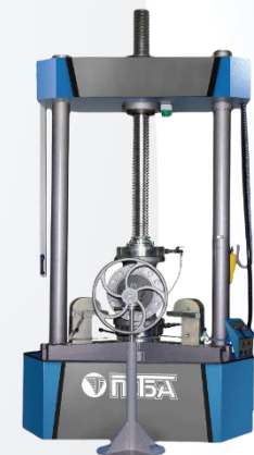
Стенд для проведения гидравлических и пневматических испытаний
